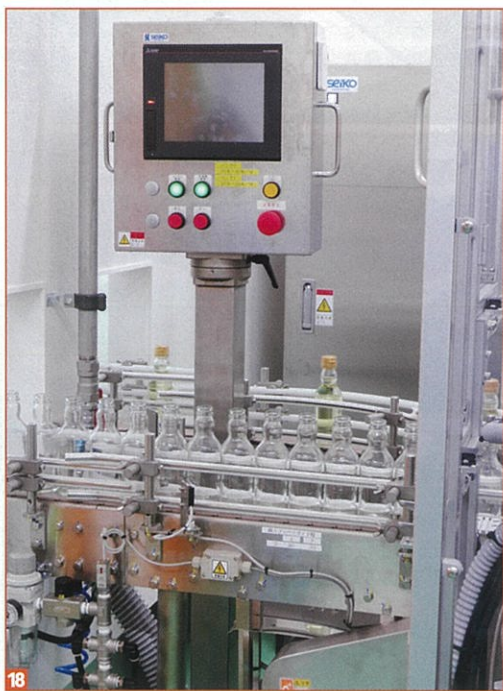
15,16,17 油はマグネットとフィルターを通し、充填機へ / 18,19 7時間稼働で1万6000本の生産能力を持つ液体充填巻締機。コンパクトで場所を取らず、能力が高い機種を選定した / 20 6本のノズルで油を充填（写真は170g）。キャップの装着状態はセンサーでチェックし、異常があれば停止する仕組みだ
