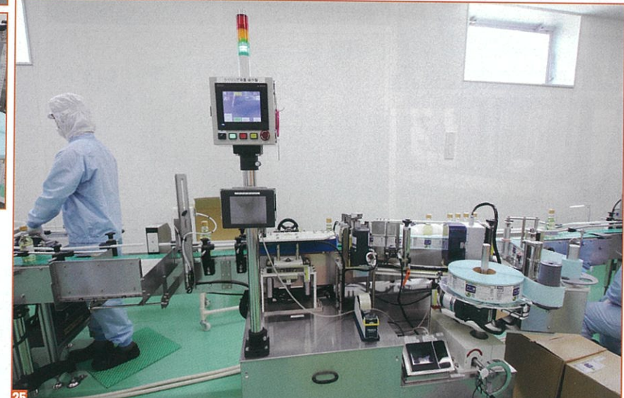
21 包装室。手前のコンベヤで右隣の充填室に空瓶を搬送し、奥のコンベヤで充填済みの製品を検査工程に搬送する／22 充填済みの製品は金属検出機とウェイトチェッカーに通す／23 重量チェックや内容量チェック、「金属感知品」などを製造日報に記載／24 LED照明を当て、異物などが混入していないか目視検品を行う／25 ラベラーでラベルを瓶に貼り、ラベルの有無や印字の有無をセンサーでチェックする
