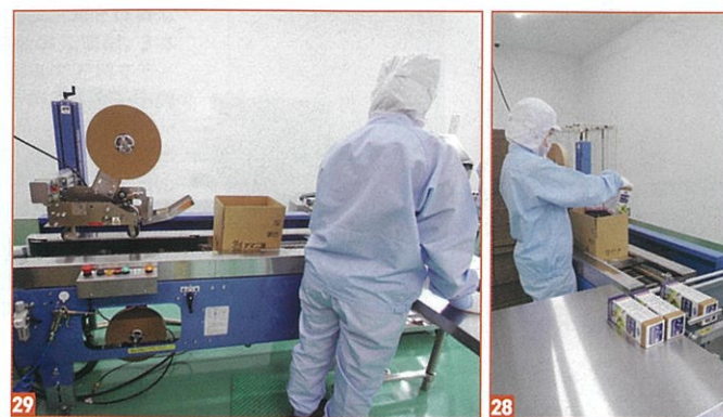
28 印字の有無や間違いを人の目でチェックしてから箱詰めする／29 半自動ケーサー。段ボールを開いて差し込むだけで製品の手投入ができる／30 印字機で段ボール側面に印字を行い、ウェイトチェッカーで重量の過不足をチェックする
