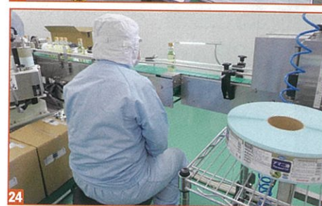
21 包装室。手前のコンベヤで右隣の充填室に空瓶を搬送し、奥のコンベヤで充填済みの製品を検査工程に搬送する／22 充填済みの製品は金属検出機とウェイトチェッカーに通す／23 重量チェックや内容量チェック、「金属感知品」などを製造日報に記載／24 LED照明を当て、異物などが混入していないか目視検品を行う／25 ラベラーでラベルを瓶に貼り、ラベルの有無や印字の有無をセンサーでチェックする
