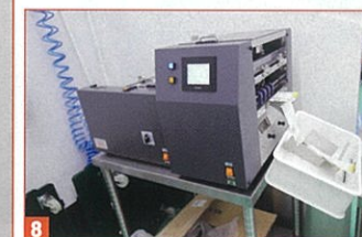
8,9 手動ラベラーと搬送機付き捺印機 / 10 充填機や印字機などの洗浄方法を記載したサニテーションマニュアル / 11 充填室と包装室の間に設けられたエアシャワー。ユニフォームに付着した異物などを清浄化された高速ジェットエアで吹き飛ばす
