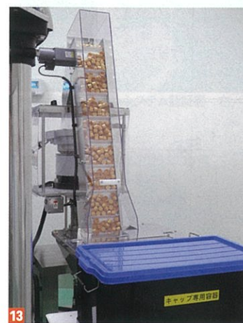
12 充填室内は陽圧で、クリーンルーム用エアコンを設置 / 13 充填機にキャップを供給する自動搬送装置 / 14 えごま油とアマニ油の系統切り替えは手動でも可能
