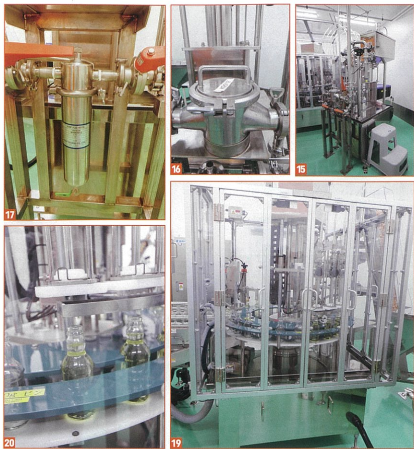
15,16,17 油はマグネットとフィルターを通し、充填機へ / 18,19 7時間稼働で1万6000本の生産能力を持つ液体充填巻締機。コンパクトで場所を取らず、能力が高い機種を選定した / 20 6本のノズルで油を充填（写真は170g）。キャップの装着状態はセンサーでチェックし、異常があれば停止する仕組みだ
