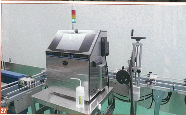
26 化粧箱に詰める作業は2カ所で行えるよう工夫した。ラインスピードを上げた際、人数を増やし柔軟に対応できる／27 インクジェットプリンターで化粧箱に賞味期限などを印字する。後工程で印字の有無などを確認しやすくするために、化粧箱は寝かせて印字。センサーを使って製品が等間隔で流れるようラインスピードを調整し、印字漏れを防ぐ
