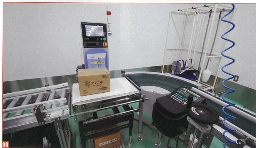
28 印字の有無や間違いを人の目でチェックしてから箱詰めする／29 半自動ケーサー。段ボールを開いて差し込むだけで製品の手投入ができる／30 印字機で段ボール側面に印字を行い、ウェイトチェッカーで重量の過不足をチェックする
