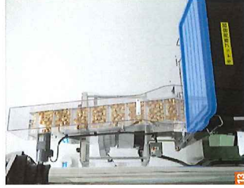
12 充填室内は陽圧で、クリーンルーム用エアコンを設置 / 13 充填機にキャップを供給する自動搬送装置 / 14 えごま油とアマニ油の系統切り替えは手動でも可能
